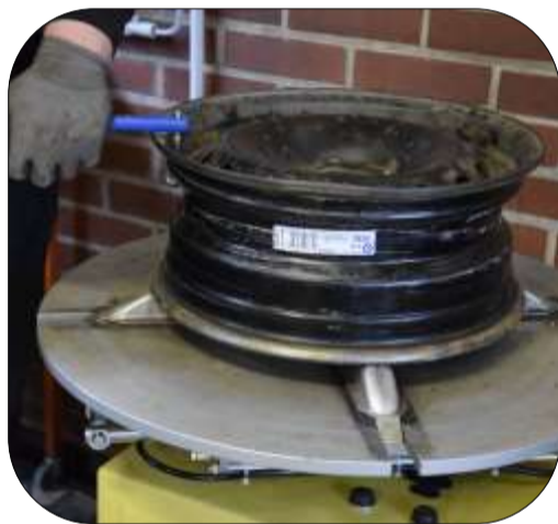
Remplacement d'une valve
