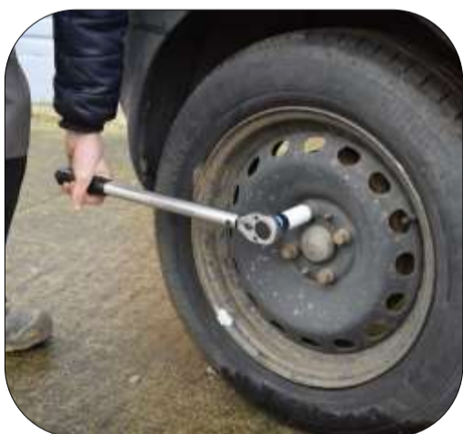
Serrage à la clef dynamométrique
